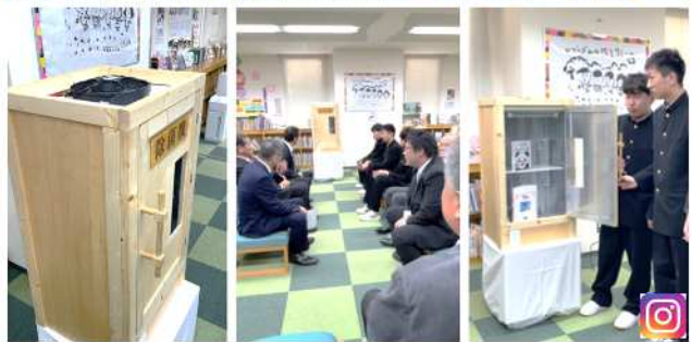
【地域連携】ものづくり研究部が本除菌機を設計・製作して、2月26日に中阪かつらぎ町長に引き渡しました。設置場所は、「かつらぎ町図書館」で、町民の皆さんに活用していただければ幸いです。そして、本を気持ち良く読んで頂き、たくさんの人に多くの本に触れてもらうことが願いです。本除菌機の製作は、第1号「県立図書館」、第2号「たまご絵本館」につづき、今回で第3号機目となります。構造は、紫外線を約10秒照射することで除菌することができます。特に工夫したところは、「安全対策」です。小さなお子様でも安心して使えるように設計し、簡単に本の除菌ができるようにしました。また、本に付着している小さなゴミも「風力」で除去することができます。アテア満載の「本除菌機」を完成することができました。今後も私達、ものづくり研究部は、「技術は、人類の希望」を合言葉に活動を行って行きます。
